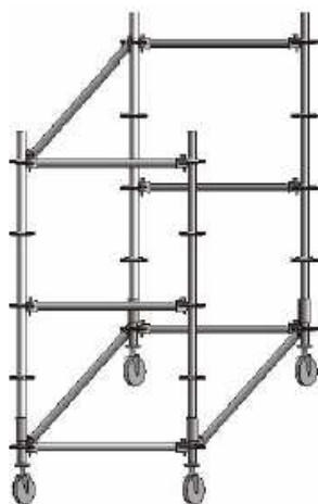
Připevnění páry tyčí 100 na úrovni podlahy a tyčí pro zábradlí o 1m výš
