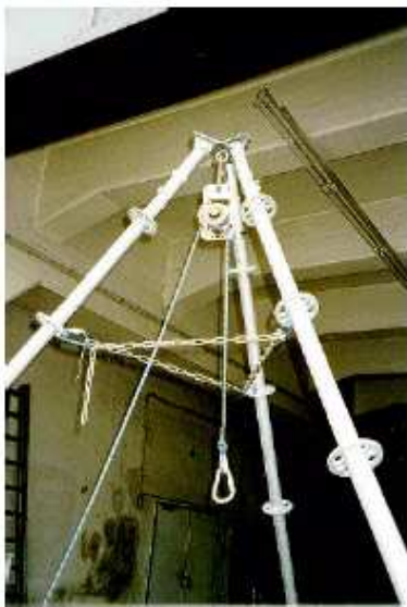
Trojhran s přípevněnou kladkou, s pojistkami proti vysunutí stojek. Obr. III / 3
