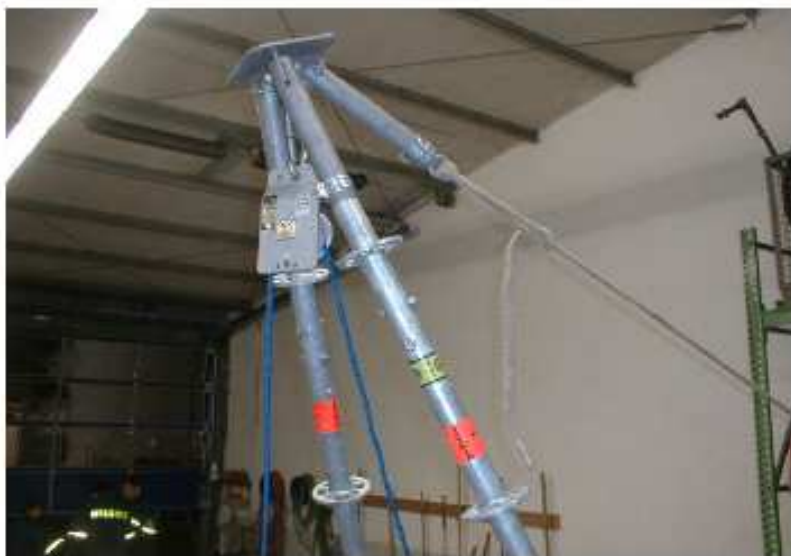
Sloupový jeřáb s upevněnou kladkou a kotvicím provazem. K záchraně osob je vždy třeba použít bezpečnostní lano. (Obr. III / 7)
