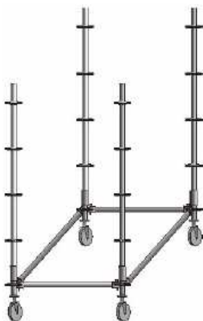
Zasunutí svislých sloupků
