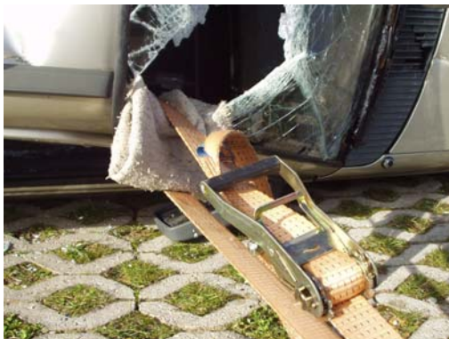
Der Spanngurt ist gegebenenfalls mit Schnittschutz zu versehen. Abb. IV / 27
