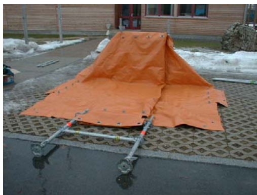
Beginn Aufbau Faltbehälter 1 x 1 m. Abb. VII / 12
