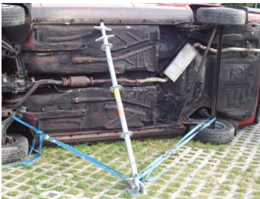
Schnellabstützung mit zwei Spanngurten zur dreidimensionalen Sicherung Abb. IV / 29
