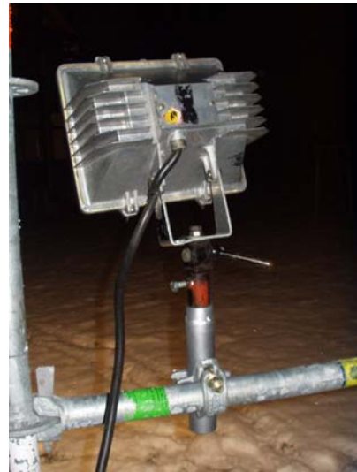
Mit Normalkupplung an Riegel fixierter Strahler Abb. IV / 34
