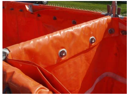
Überlappung der Mehrzweckplanen zur fugenfreien Verbindung der Behälter.
