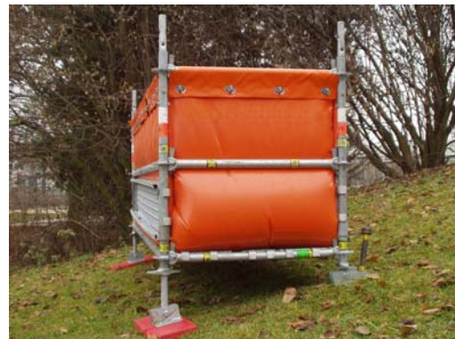
Fertiger Faltbehälter am Hang Abb. VII / 29
