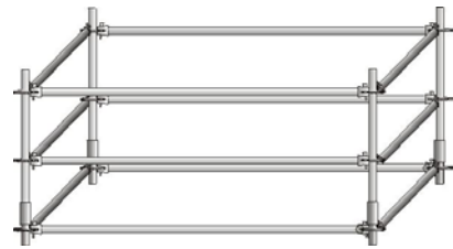
Einbau der Riegel Abb. VII / 5
