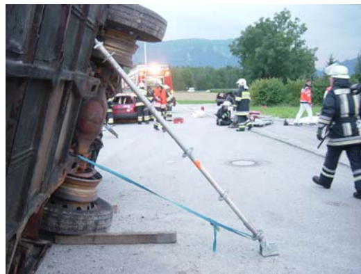
Schnellabstützung mit Vertikalstiel 200 an Unfallbus Abb. IV / 30
