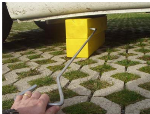
Schürhaken zum Ausrichten der Rüsthölzer (Abb. A / 10)
