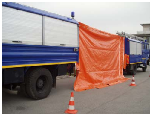
MZP als Seitenschutz mit Leine aufgespannt Abb. VII / 34
