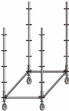
Aufstecken der Vertikalstiele
