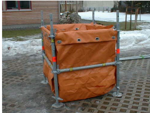
Faltbehälter 1 x 1 m. Abb. VII / 10
