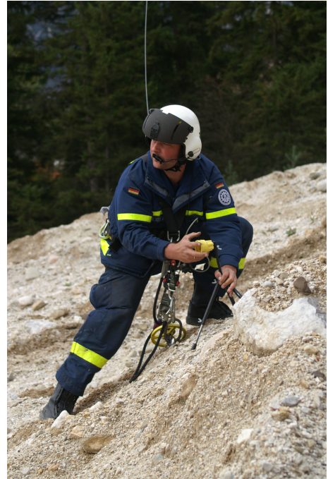
Einbringung Messpunkt in Murenkörper via Winch (Abb. II / 29b)
