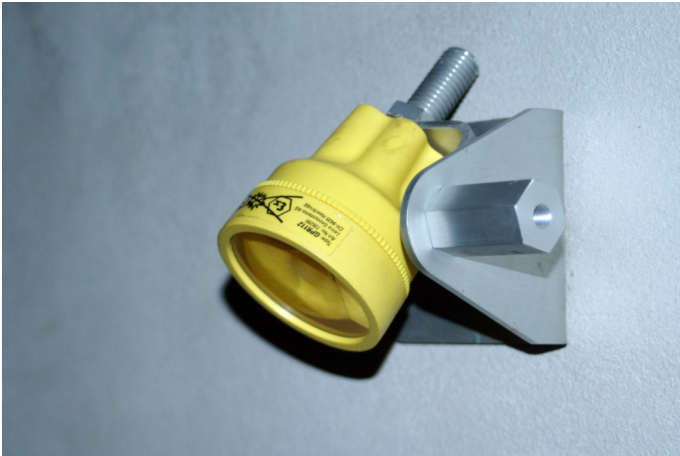
Das befestigte Prisma wird ausgerichtet (Abb. II / 24)
