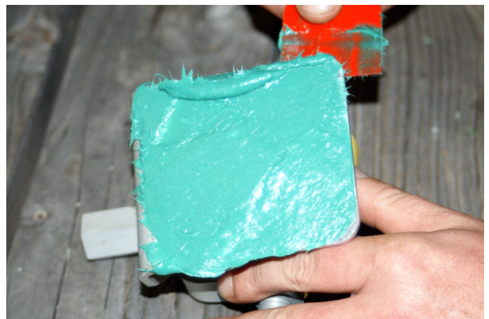
Fertige Spachtelmasse nach Bedarf 1 - 3 mm dick auf die Unterseite des Prismenwinkels auftragen (Abb. II / 17)
