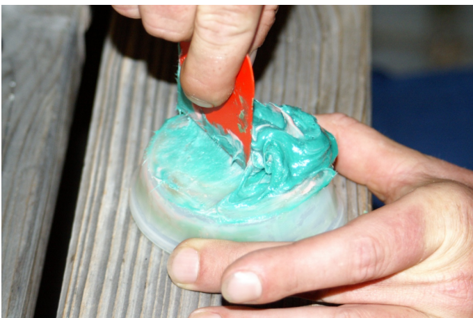
Beide Komponenten vermischen, bis eine gleichmäßig gefärbte homogene Masse entsteht (Abb. II / 16)
