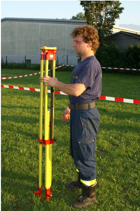
Ausfahren der Stativ-Beine (Abb. II / 3)
