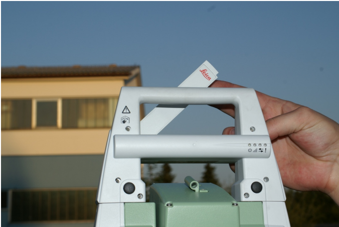
Ausklappen der Funkantenne (Abb. II / 7)
