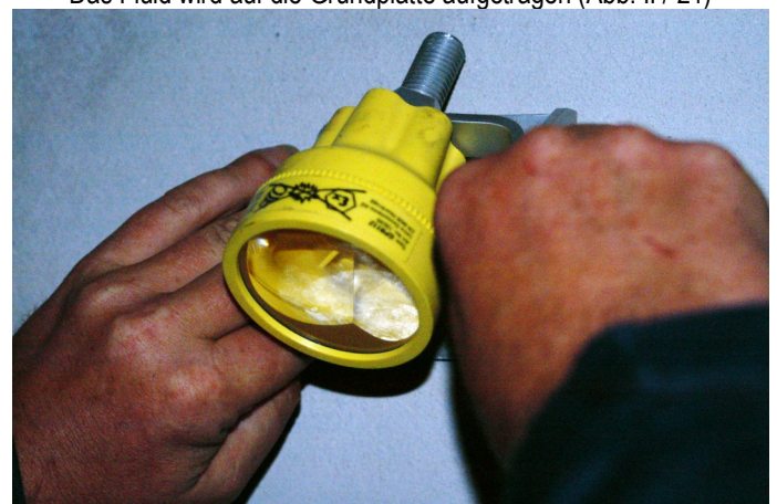
Die Befestigungsplatte wird für 20 - 40 Sekunden angepresst (Abb. II / 23)
