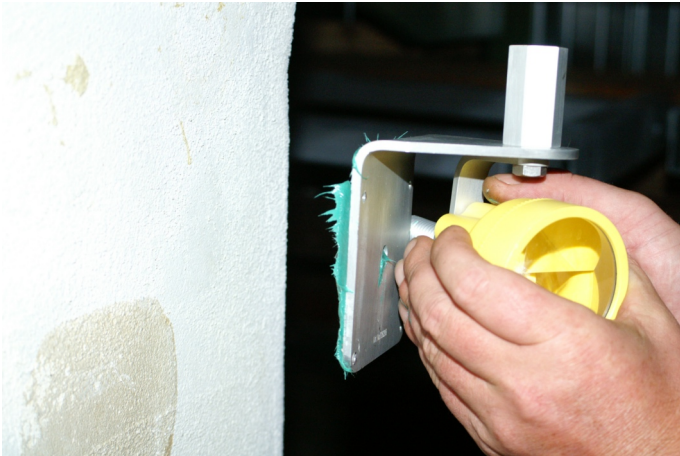
Prismenwinkel am Objekt andrücken und je nach Außentemperatur zwischen 20 Sekunden und zwei Minuten andrücken (Abb. II / 18)
