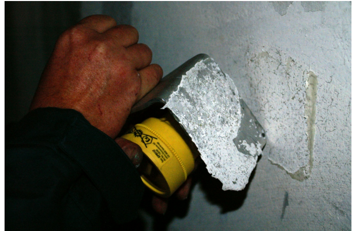
Auch hier hält der Kleber besser als der Putz (Abb. II / 25)
