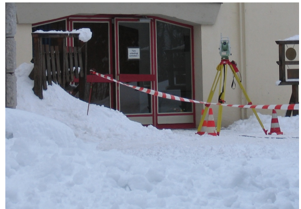
Langzeitbeobachtung von Schneelasten (Abb. IV / 2)
