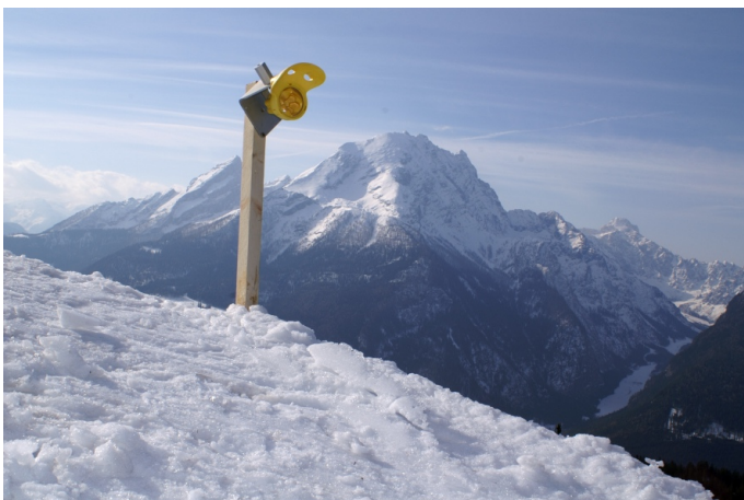
Prisma mit Wetterschutzschild an Pflock zur Überwachung von Schneefeldern (Abb. II / 28)
