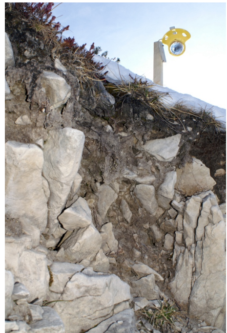
Prisma an Pflock zur Überwachung einer Lockerstein-Abrisskante (Abb. II / 29)
