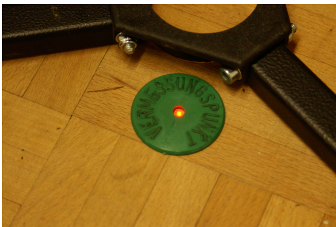
Sicherung des Standortes mittels Vermessungspunkt (innen ist das
