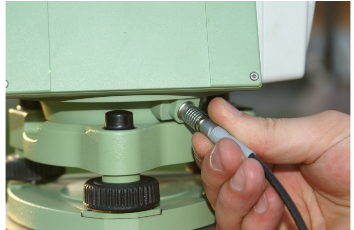
Anstecken des Stromkabels (Abb. II / 8)
